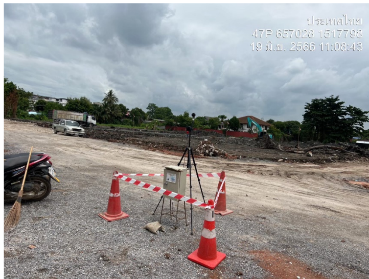
บริษัท ทีเอ็นพี เอ็นไวรอนเม้นท์ จำกัด เข้าติดตั้งเครื่องตรวจวัดระดับเสียง
